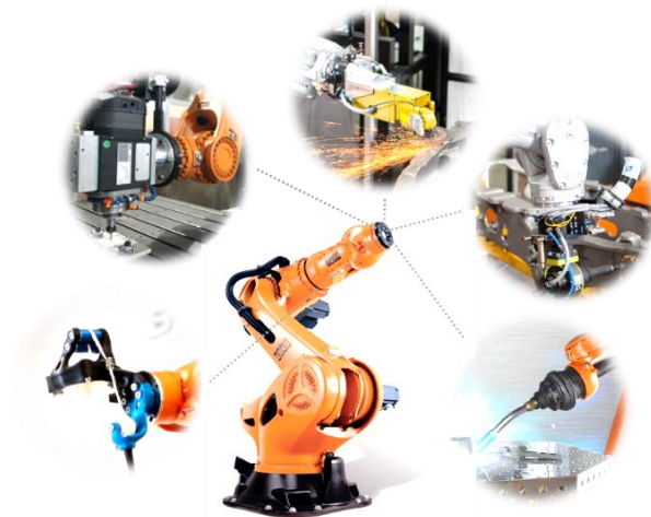
Figure 4 Exemple de robot industriel à outils interchangeables
