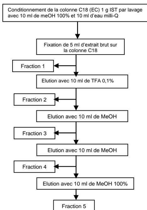
**Figure 9.6** : Procédure de fractionnement des facteurs de sporulation sur colonne C18.
