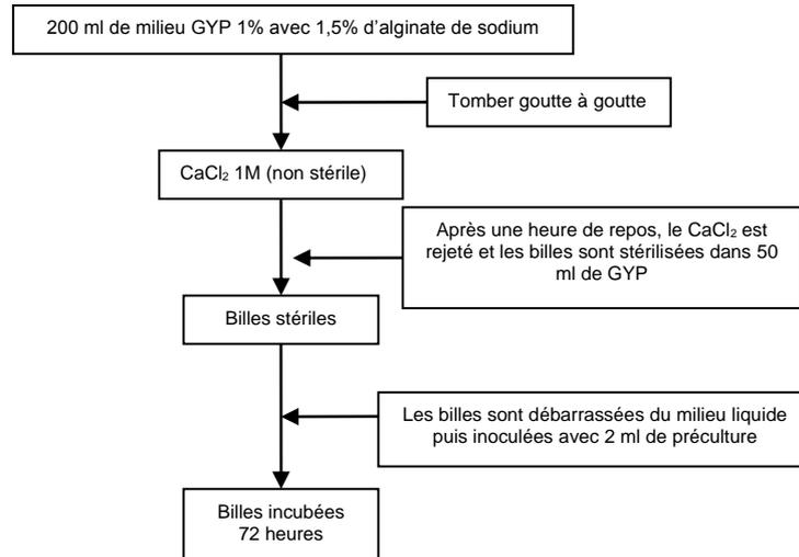
**Figure 9.2 :** Procédure de culture des cellules sur des billes d'alginate préformées.
