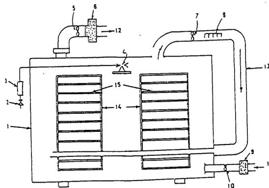
**Figure 16.1** : Fermenteur pour substrat solide sur plateaux (selon Mitchell *et al.*, 1992). 1.Chambre de fermentation; 2.Valve; 3.Tube UV germicide; 4.Humidificateur; 5.Ventilateur; 6.Filtre; 7.Ventilateur; 8.Chauffage; 9.Filtre à air; 10.Ventilateur; 11.Entrée d'air; 12.Sortie d'air; 13.Tuyau de circulation d'air; 14.Armature; 15. Plateaux perforés.
