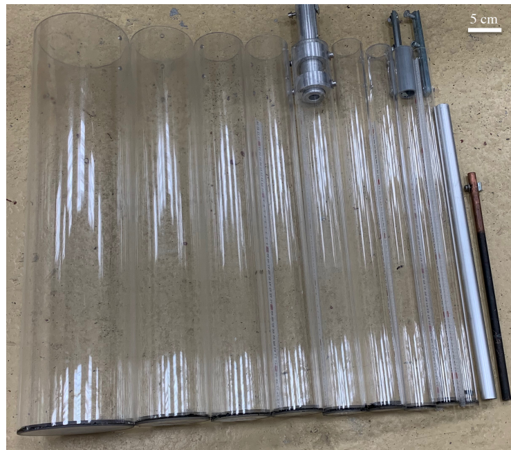
FIGURE 2.3 – Cylindres en polyméthacrylate de méthyle (PMMA) utilisés pour les expériences
