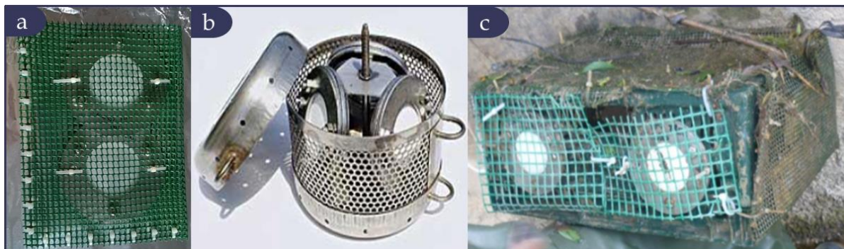
Figure 26 – (a) Duplicat de POCIS HLB introduit dans les pochettes grillagées utilisées pour leur déploiement sur le terrain ; Cages ajourées en inox (b) ou en plastique (c) couramment utilisées pour protéger les POCIS lors de leur déploiement in situ (Bailly, 2013; Poulhier, 2014).
