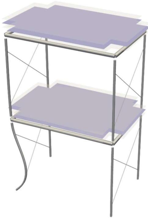
Figure 3.34 : Exemple de déformée statique supplémentaire pour la structure souple.
