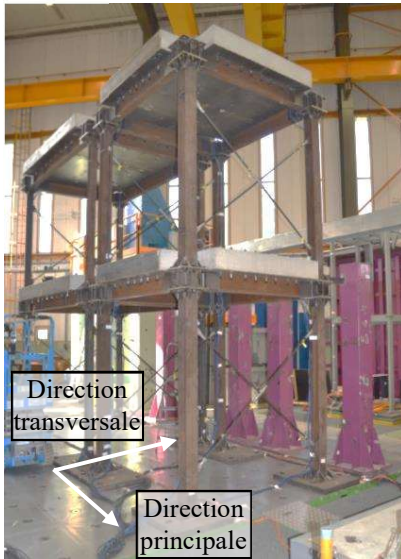
Figure 3.3 : Configuration des maquettes expérimentales sur la table vibrante Azalée pour la réalisation des essais sismiques.
