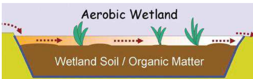
Figure 14 : Schéma d'une lagune aérobie plantée (Zipper et al., 2014)
