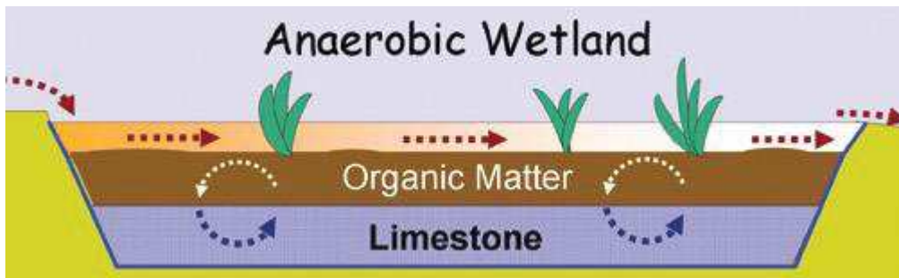
Figure 13 : Schéma d'une lagune anaérobie plantée (Zipper et al., 2014)
