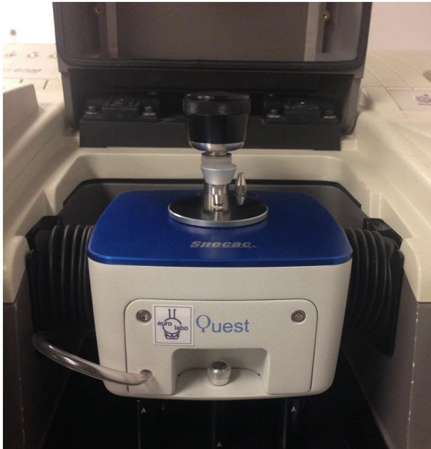
Figure 2.7 - Dispositif expérimental utilisé pour les mesures en ATR : Spectromètre Nicolet 7600 FTIR combiné à un accessoire Quest ATR Specac
