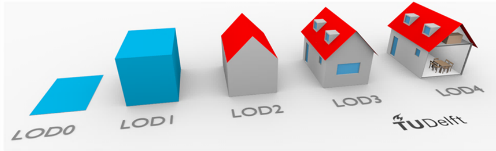
FIGURE 4.10 – Niveaux de détail de la description des géométries urbaines (d'après Biljecki et al. (2016))
