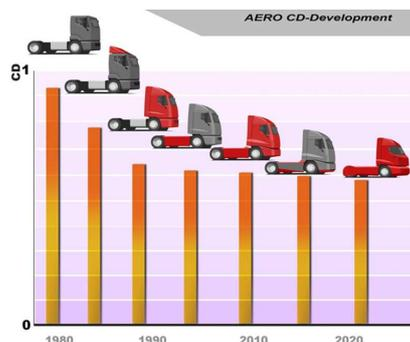
FIGURE 2.1:  volution du coefficient de tra n e des poids lourds, d'apr s Volvo Trucks.
