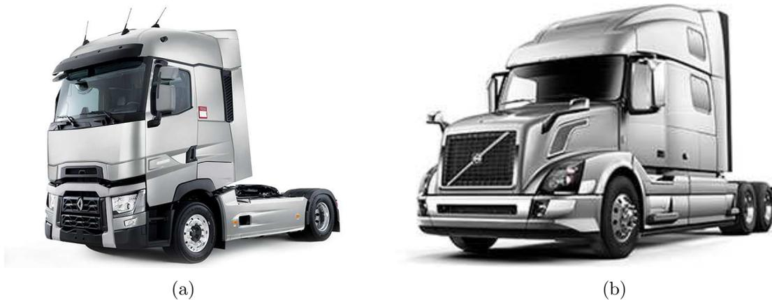
FIGURE 1.2: Exemple de cabines COE, le Renault Trucks Range T (a) et conventionnelle, le Volvo VNL (b).
