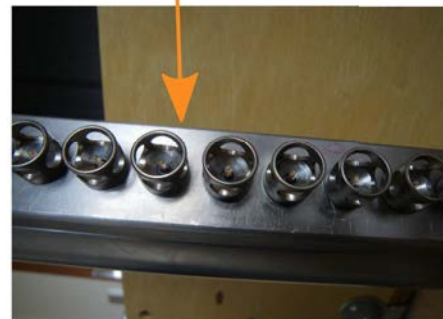
FIGURE 8.3 – Barre de thermistors prêtée par le NIOZ et composée de 32 capteurs de température espacés de 1.5 cm.
