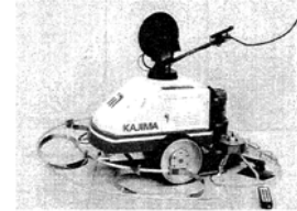
Figure 130 MARK 1, 2 et 3, unité mobile autonome pour le lissage de chape (Tanaka et al., 1986)
