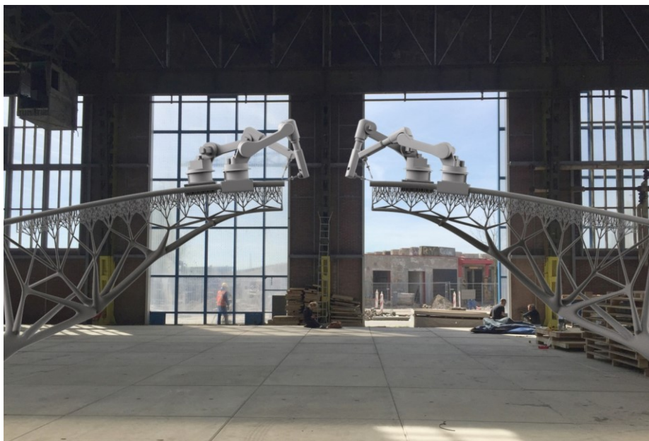
Figure 24 Projet d'impression d'un pont métallique - MX3D - 2014 - Amsterdam
