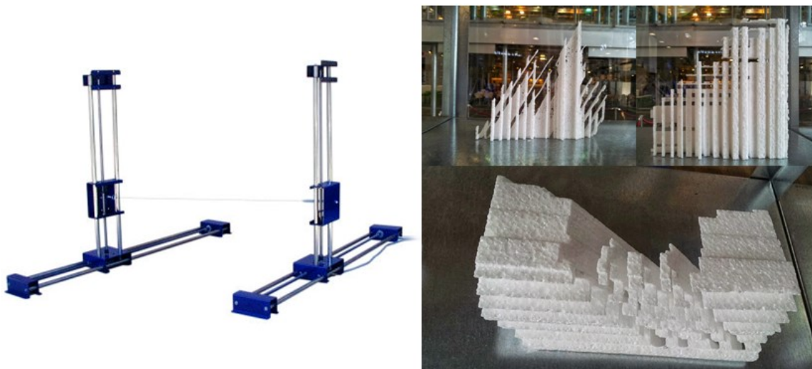
Figure 86 Machine de découpe au fil chaud (G) Exemple de réalisations (D)
