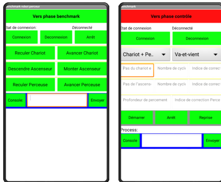
Figure 140 Interface de commande pour les tests de mouvements et interface de contrôle pour les tests de prise en main chantier
