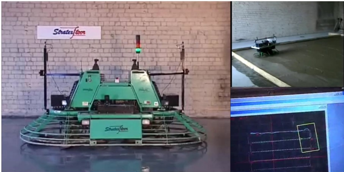
Figure 132 ROBOTUS- Système autonome de guidage sur lisseuse mécanique autoportée (STRATEX FLOOR, 2014)
