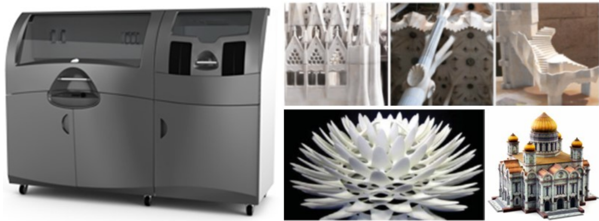
Figure 90 Imprimante 3D par fixation de poudre(G) Exemple de réalisations(D)
