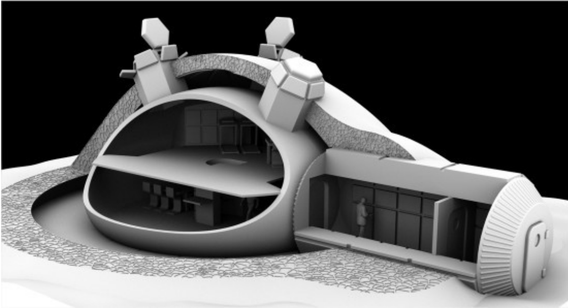
Figure 19 - Image de synthèse représentant un abri lunaire construit par fabrication additive (Foster + Partners, 2013)
