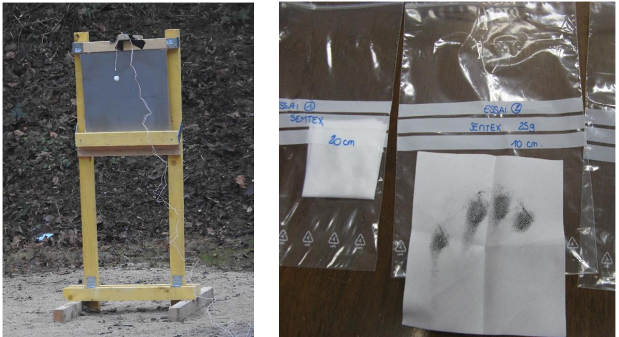
Figure 46 : plaque métallique et formulation énergétique pré-détonation (gauche) et résidus d'explosion collectés à la surface du support de prélèvement (droite)
