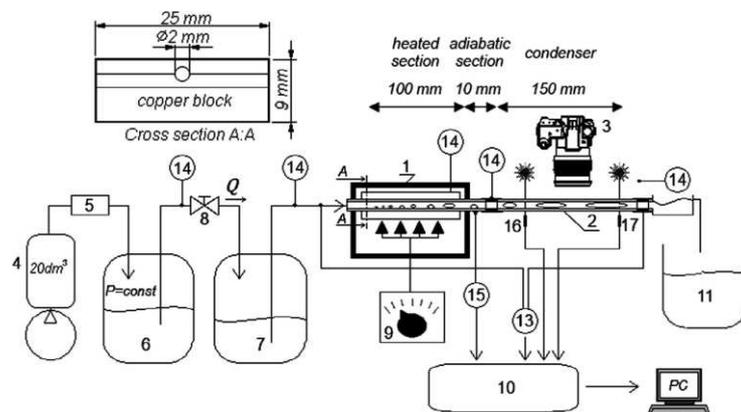
Figure 61 : Dispositif expérimental d'observation des oscillations de pression dans un écoulement avec ébullition et condensation (79)
