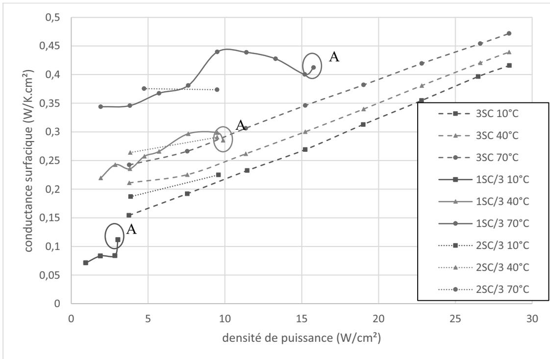
Figure 199 : Conductance surfacique en fonction de la densité de puissance pour différents dispositifs et différentes températures de source froide (méthanol,  $TR = 50\%$ )
