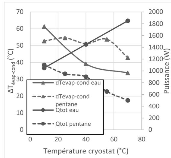
**Figure 186 :  $\Delta T_{\text{évap-cond}}$  et puissance avant assèchement en fonction de la température de source froide ( $TR = 50\%$ )**
