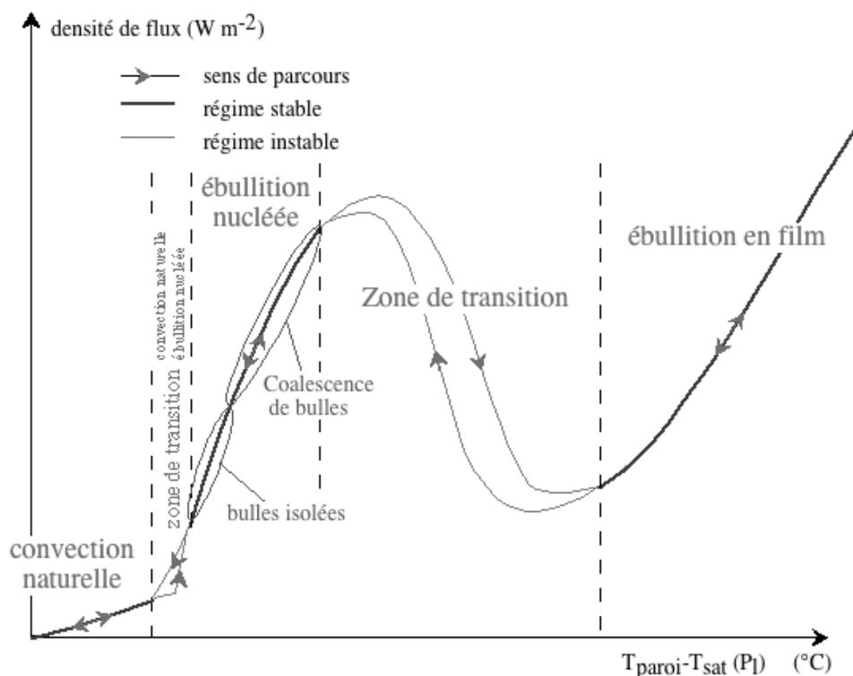
Figure 9 : Courbe d'ébullition au niveau d'une paroi immergée en température imposée (16)
