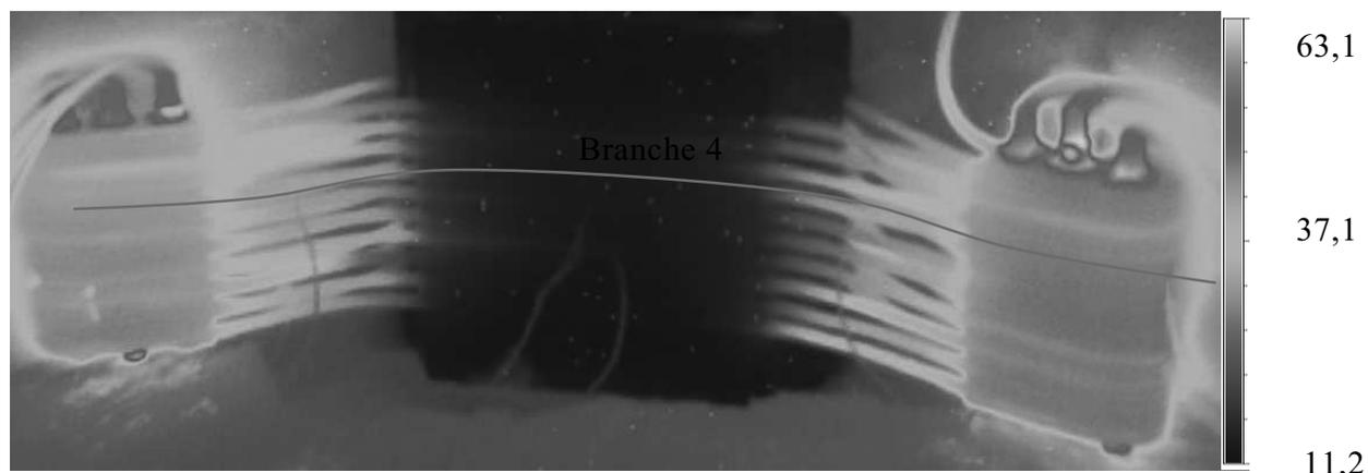
Contrairement aux mesures effectuées avec les thermocouples, les relevés IR permettent une acquisition rapide sur un grand nombre de points mais seulement sur une seule face du dispositif. L'analyse de l'évolution de la température par l'exploitation des images IR
