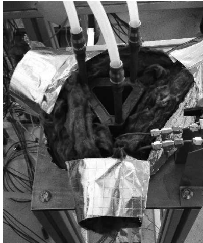
Figure 115 : Photo du dispositif expérimental à sources multiples avec isolation.
