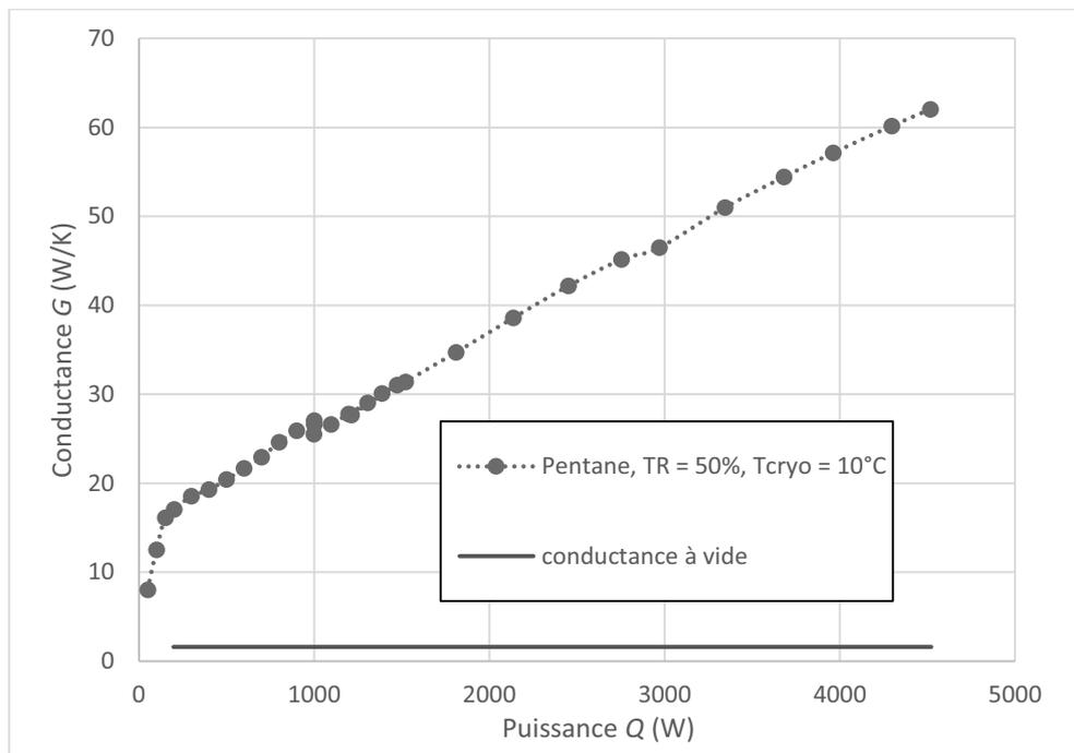
Figure 152 : Conductance globale avec la puissance (pentane, TR = 50 %, T<sub>cryo</sub> = 10°C)
