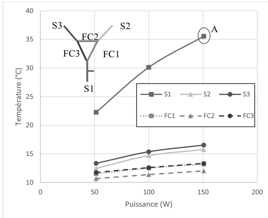
Figure 188 : Température dans chaque source de l'évaporateur et chaque face du condenseur en fonction de la puissance injectée dans la source 1 (pentane,  $TR = 50\%$ ,  $T_{cryo} = 10^\circ\text{C}$ ,  $Q_2 = Q_3 = 0\text{ W}$ )
