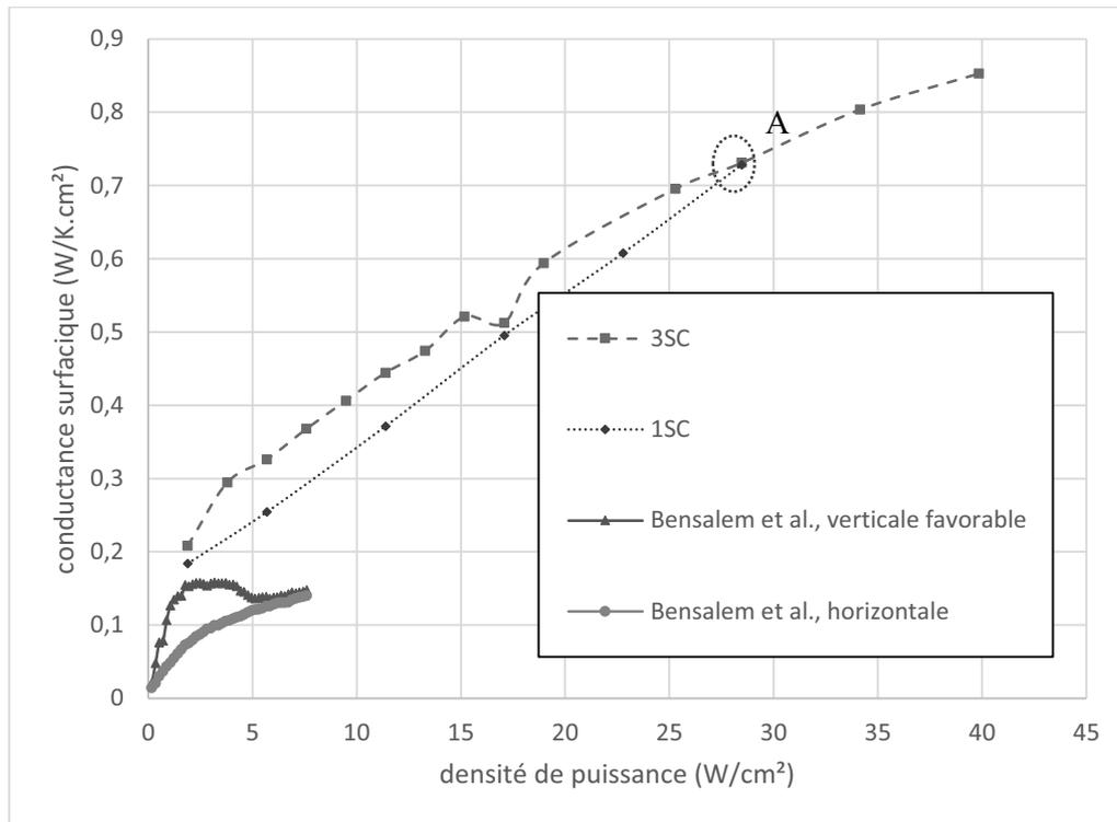
Figure 138 : Conductance surfacique en fonction de la densité de puissance pour différents dispositifs et différentes températures de source froide (eau,  $TR = 50\%$ ,  $40^{\circ}C$ )
