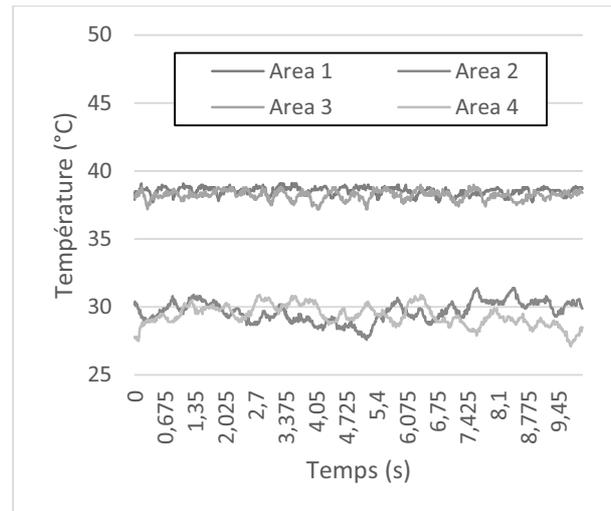
**Figure 170 : Evolution temporelle de la température mesurée par visualisation IR dans les zones de mesures (méthanol,  $TR = 50\%$ ,  $T_{cryo} = 10^{\circ}\text{C}$ ,  $Q = 600\text{ W}$ )**
