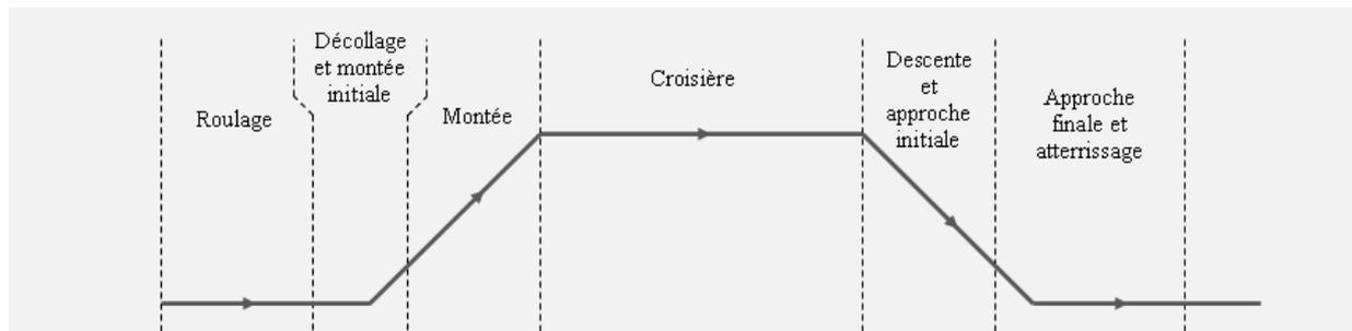
Figure 101 : Schéma des différentes phases lors d'un vol
