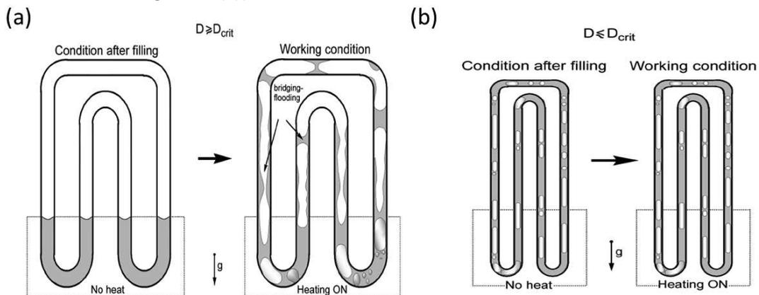
Figure 8 : Type de fonctionnement selon diamètre critique (15)
