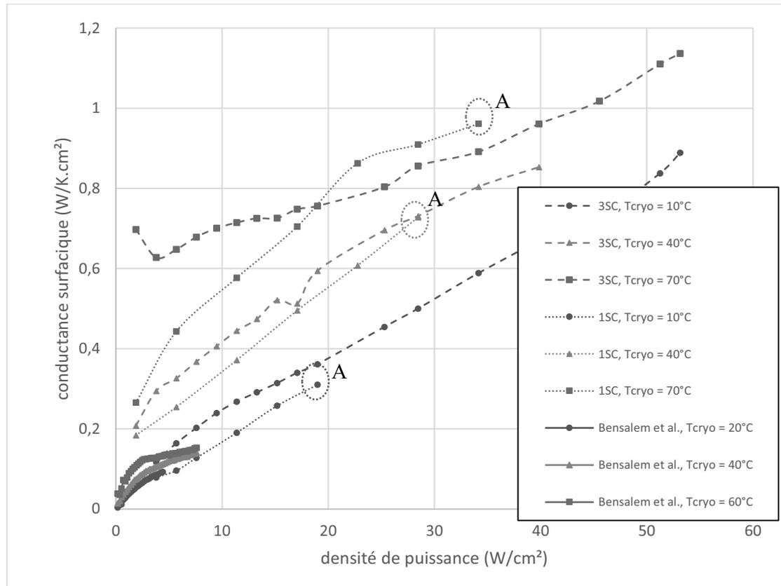
Figure 137 : Conductance surfacique en fonction de la densité de puissance pour différents dispositifs et différentes températures de source froide (eau,  $TR = 50\%$ )
