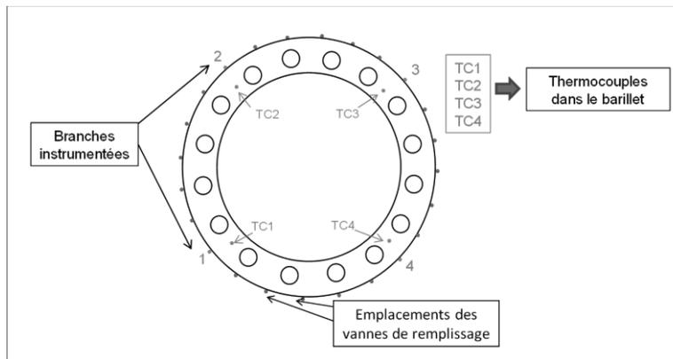
Figure 75 : Schéma des branches instrumentées sur une vue en coupe
