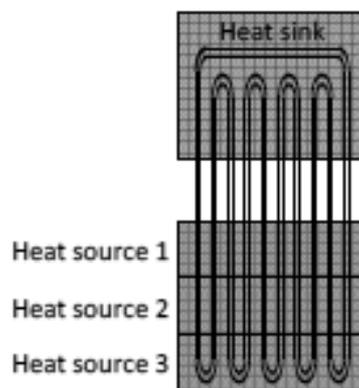
Figure 34 : Chauffage non-uniforme le long d'un caloduc oscillant (53)
