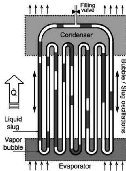
Figure 1 : Schéma de principe du caloduc oscillant (10)
