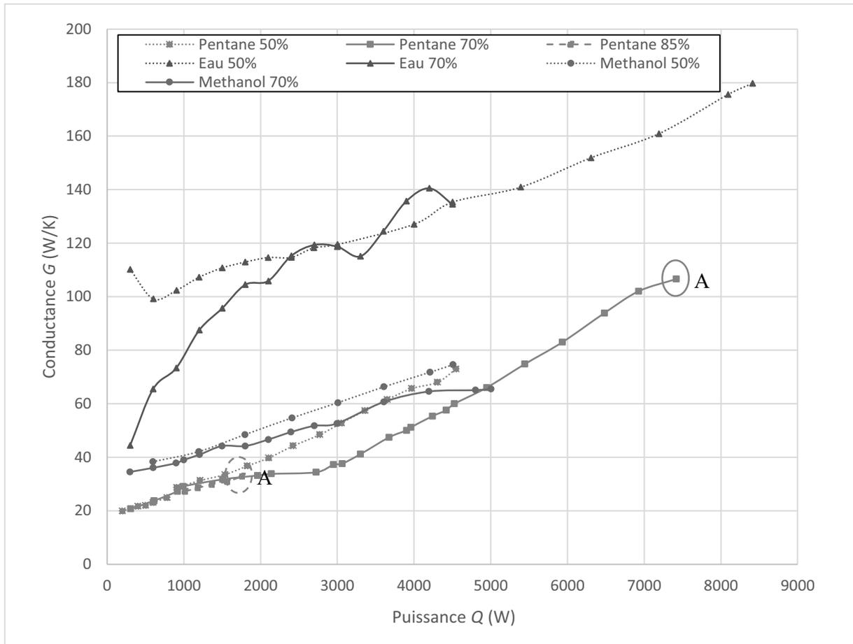
Figure 168 : Conductance en fonction de la puissance pour les trois fluides ( $T_{cryo} = 70^{\circ}\text{C}$ )
