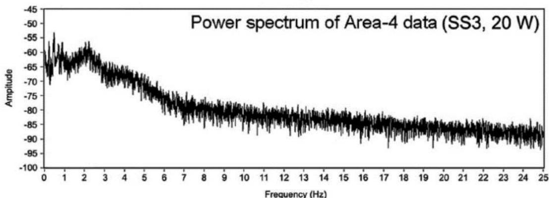
Figure 66 : Densité de puissance spectrale pour l'état SS3 (10)
