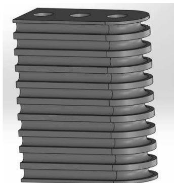
Figure 117 : Schéma bloc de chauffe
