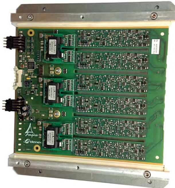
FIGURE 5.14: Photographie de la carte allumeur 6 voies incorporant la commande proposée
