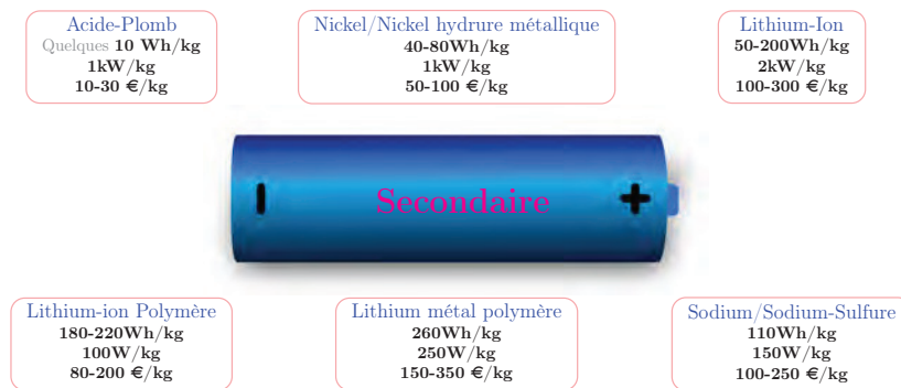
FIGURE 1.15: Technologies de stockage électrochimiques secondaires actuellement disponibles sur le marché accompagnées de leurs densités d'énergie et de puissance et leurs prix par kilogramme selon [166]
