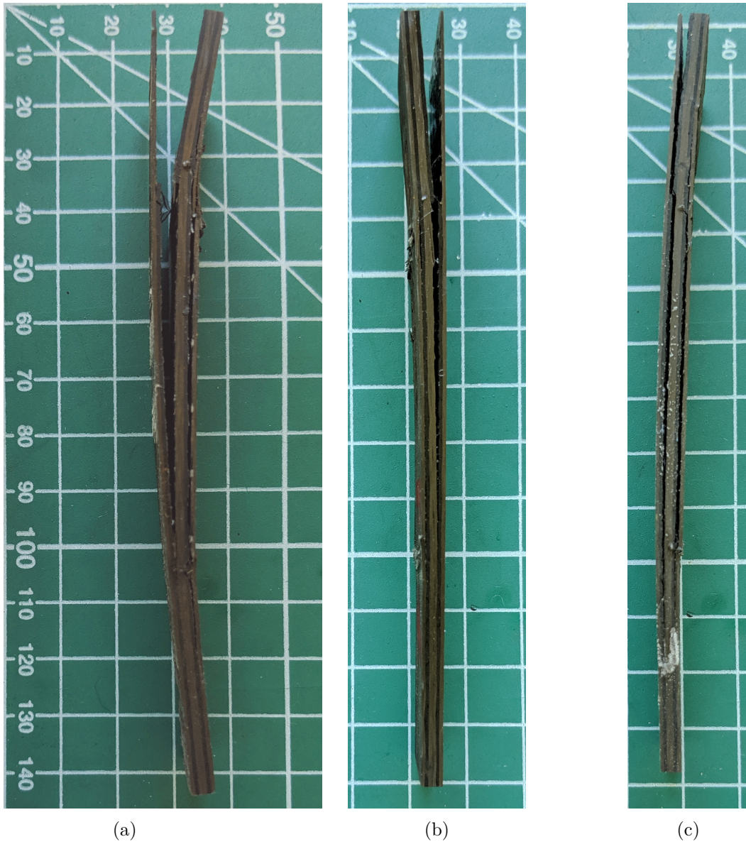
FIGURE A.10 – Exemple de rupture par délaminage suite à un chargement de flexion 4 points en fatigue
