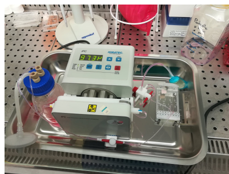
(b) Photographie du dispositif de perfusion hors étuve.
