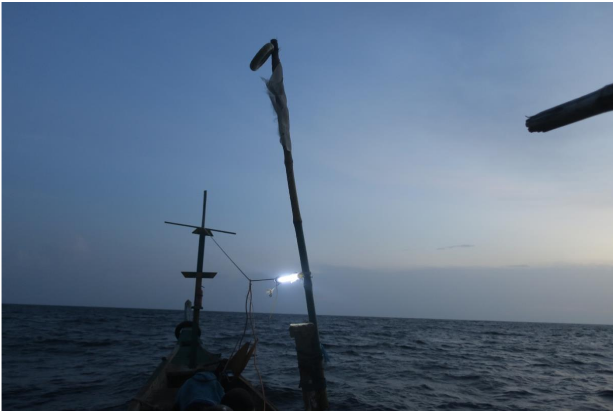
photographie 5 Un néon alimenté par une batterie de voiture sert de source de lumière à la pirogue, elle reste allumée toute la nuit pour signaler la présence de la pirogue aux embarcations de passage : autres pirogues, chalutiers, paquebots, porte-containers, etc.
