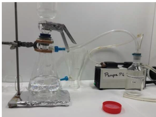
Figure 39. Système de filtration des échantillons d'eau.
