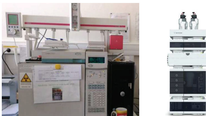
Figure 40. Exemple du GC- \mu ECD utilisé lors des analyses PCB et PBDE (à gauche) et de la chaîne de chromatographie liquide utilisée pour les analyses de l'HBCD (à droite).
