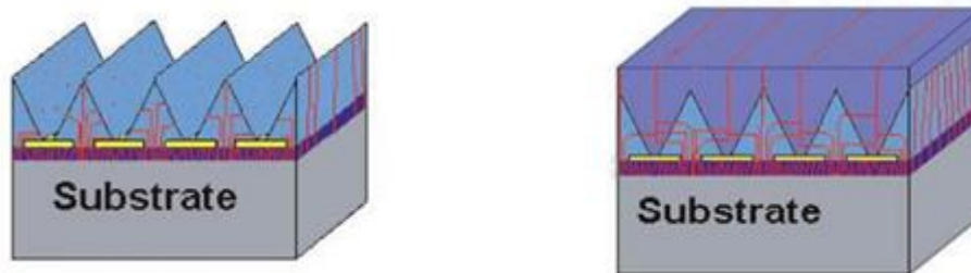
Figure 3.11 : schéma représentatif du phénomène de la courbure des dislocations sur des substrats planaires.
