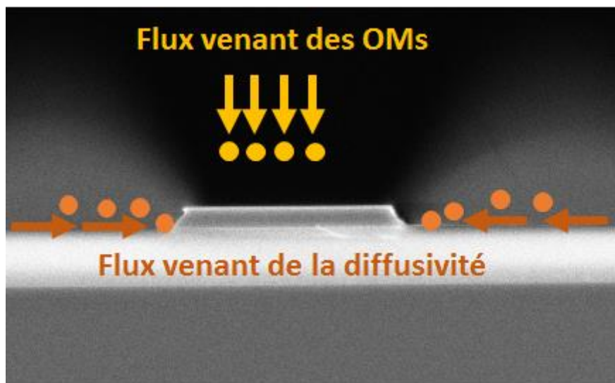
Figure 4.20 : schéma explicatif de la compétition des flux de GaN venant de la diffusion latérale sur la surface et le flux direct venant des organométalliques.
