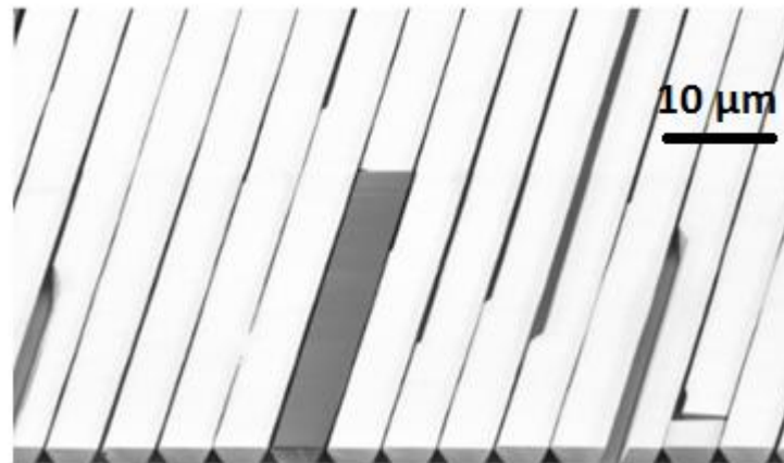
Figure 5.9: image MEB de la croissance des bandes GaN à vitesse réduite sur des substrats ART.
