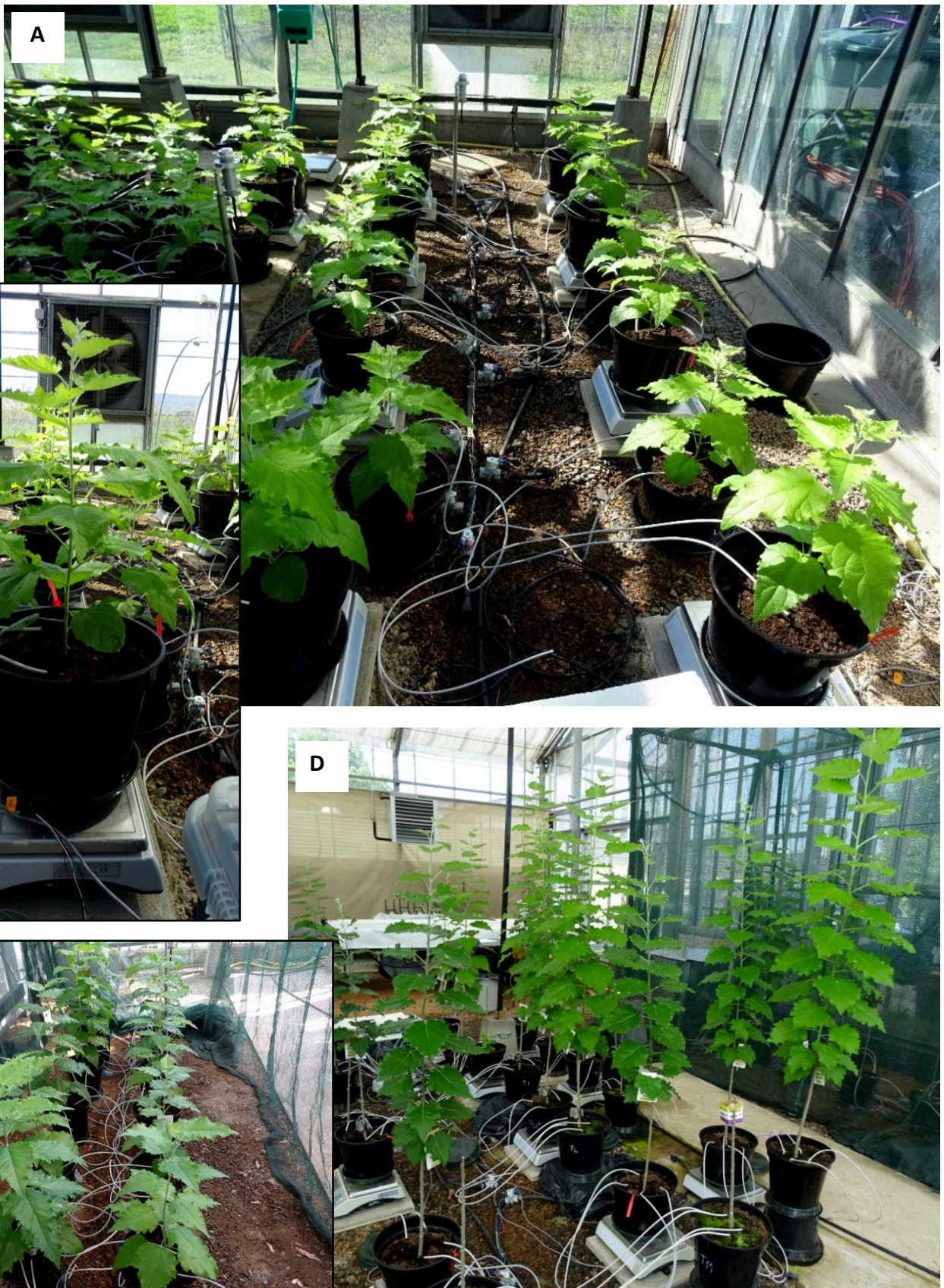
Figure 40 : Dispositif expérimental en serre. A : vue du dispositif lors de la mise en croissance des plants. B : vue à la même date d'un plant LD et de la balance permettant de piloter son irrigation. C : vue trois semaines plus tard des plants en condition SW. D : vue du dispositif le jour de la récolte.
