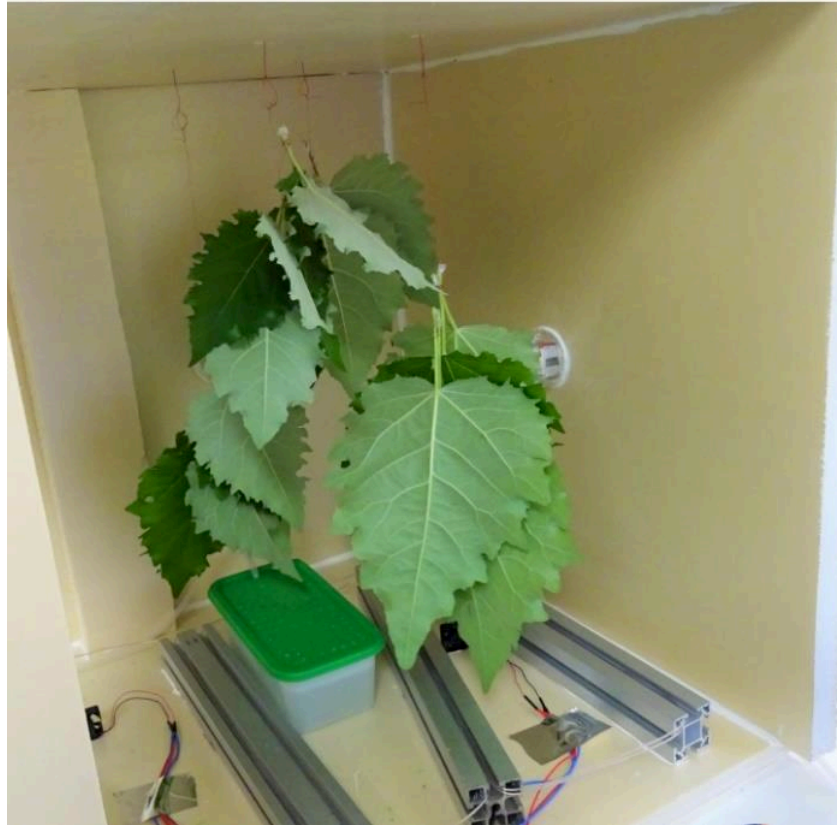
Figure 54 : Dispositif prototype « Drought Box », utilisé pour le phénotypage du g_{\min} de feuilles de peuplier. Dans cette enceinte isolée, humidité relative et température sont finement contrôlées. Le suivi de la perte de masse des feuilles par les jauges de contraintes auxquelles elles sont suspendues permet de calculer leur conductance minimale.
