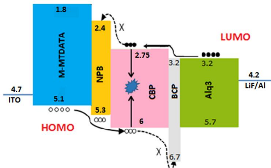
Figure 4. 2 Diagramme des bandes de l'hétéro-structure OLED
