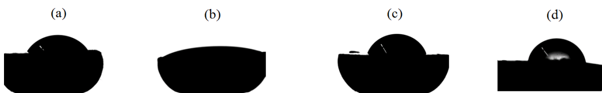
FIGURE 2.11 – Etalement d'une gouttelette de (a) CTAB, (b) DDAB, (c) Brij 58 et (d) Zephrym PD 7000 sur une pastille de cire (Figure extraite de la référence [4]).
