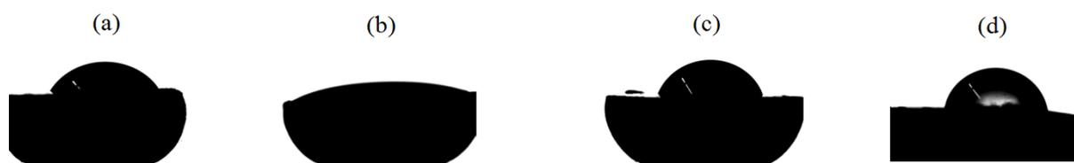
FIGURE 2.11 – Etalement d'une gouttelette de (a) CTAB, (b) DDAB, (c) Brij 58 et (d) Zephrym PD 7000 sur une pastille de cire (Figure extraite de la référence [4]).
