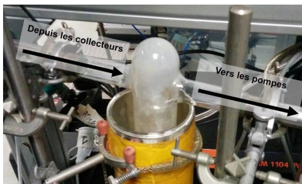
Figure II - 13 : Le piège froid, intercalé entre les collecteurs et le système de pompage
