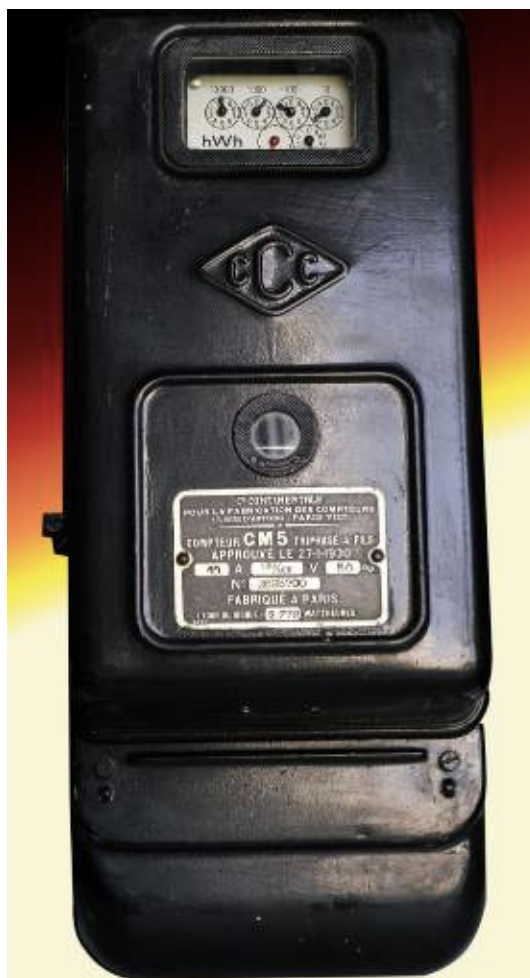
Fig. 5 — Compteur à induction, puissance estimée à 6,92 kW, 1930 (Source : Ph. Maillat, 2016) 1
