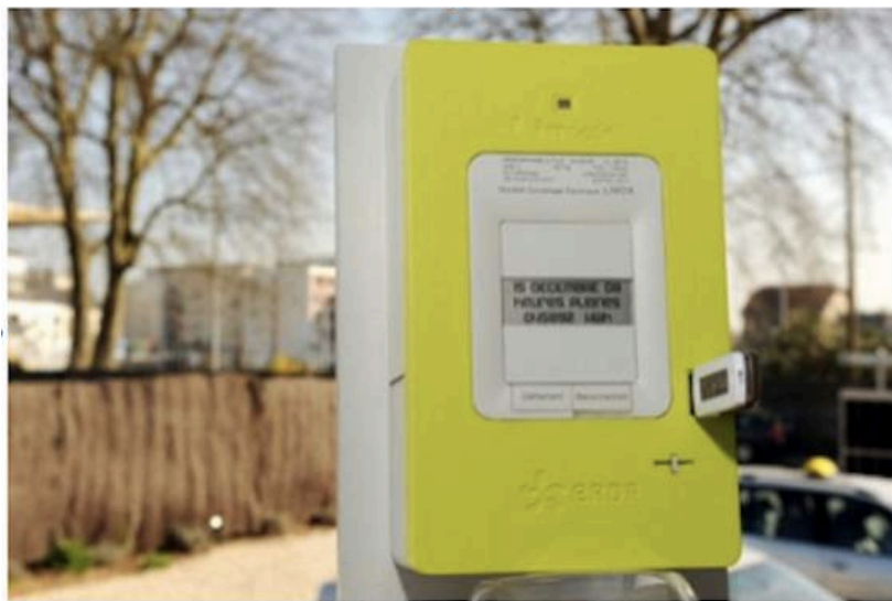
Le nouveau compteur électronique baptisé Linky, appelé à remplacer les 35 millions de compteurs électriques équipant les foyers français. (AFP)
