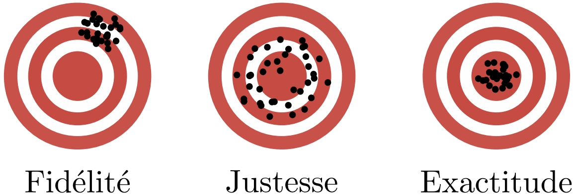
FIGURE 2.3 – Illustration des notions de fidélité, de justesse et d’exactitude dans le cadre du calcul numérique. Chaque point noir représente le résultat d’une exécution. Ces points se confondent si l’exécution est déterministe. L’exactitude est une propriété forte qui demande à la fois la fidélité – que les résultats empiriques ne soient pas trop éloignés les uns des autres – et la justesse – que la moyenne des résultats empiriques soit centrée sur le résultat théorique.
