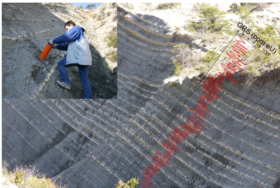
Figure 45 : Acquisition de données de gamma-ray spectral (GRS) sur le terrain permettant d'obtenir le signal sédimentaire utilisé pour le calage orbital des séries sédimentaires (coupe de La Charce, Valanginien).
