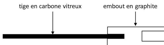
**Figure III-4 : Schéma de l'électrode auxiliaire pour les études analytiques**
