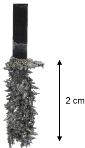
Figure V-14 : Photographie d'un dépôt de zirconium obtenu sur une cathode en graphite après un électroraffinage à -0,14 \text{ A.cm}^{-2} pendant 3,2 heures (avancement théorique de 83 %) dans \text{LiF-NaF-ZrF}_4 ( m_0 = 1,96 \text{ mol.kg}^{-1} ) à 750^\circ\text{C}
