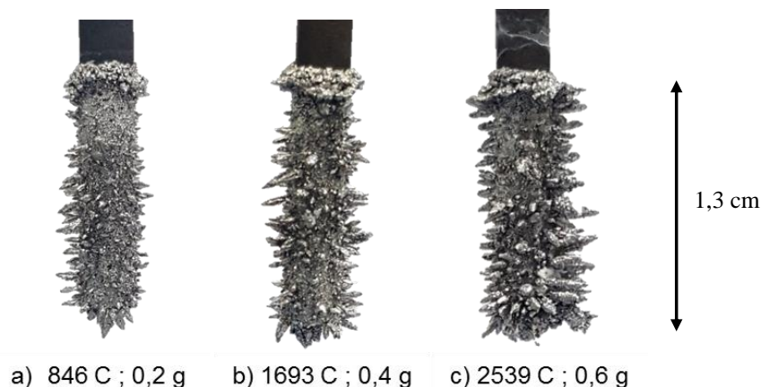
Figure IV-25 : Photographies de dépôts de zirconium sur carbone graphite pour différentes quantités d'électricité dans \text{LiF-NaF-ZrF}_4 ( m_0 = 1,96 \text{ mol.kg}^{-1} ) à 750 \text{ }^\circ\text{C} pour une densité de courant constante de -0,10 \text{ A.cm}^{-2}
