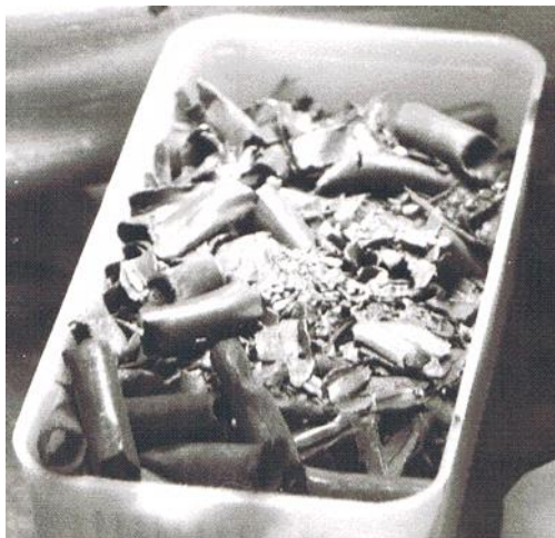
Figure I-4 : Photo de coques industrielles en sortie du dissolvant
