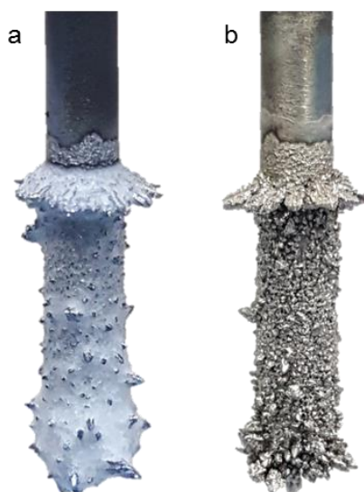
Figure IV-20 : Photo d'un dépôt de zirconium sur une cathode en zirconium (a) avant et (b) après nettoyage aux ultrasons
