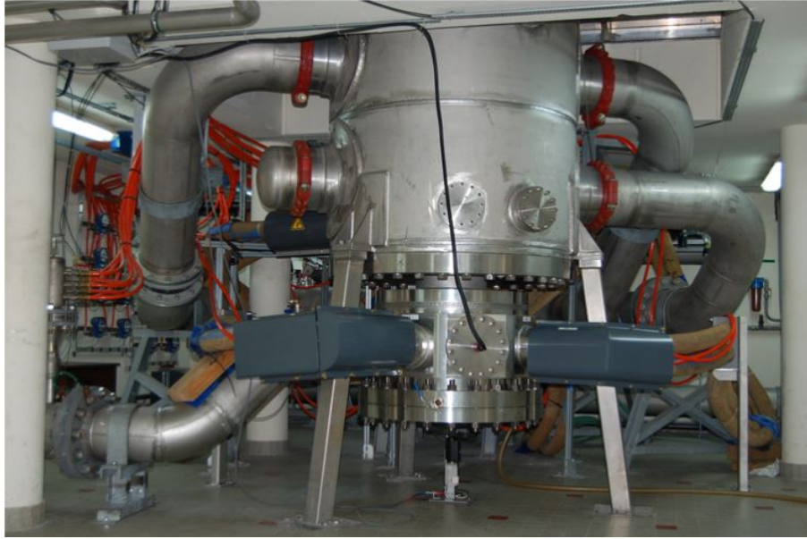
FIGURE 2.8 – Caisse contenant un aimant résistif du LNCMI-G. Un blindage épais de 10 cm en acier inoxydable permet de résister aux efforts mécaniques très importants dus à la force de Lorentz qui s'exercent sur l'aimant.
