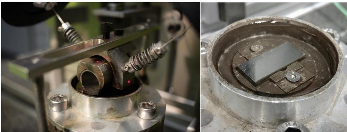
FIGURE 2.4 Photographies de l'ensemble projectile (gauche) et de l'ensemble cible (droite)
