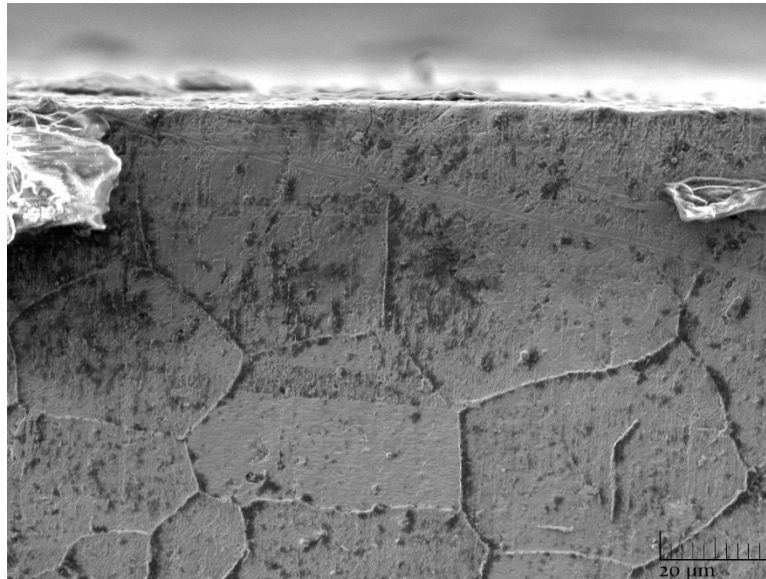
FIGURE 5.2 Microstructure du tube GV sous la zone usée au grossissement x 2000
