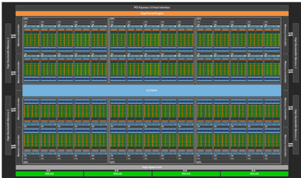
Figure 16 : Architecture d'un GP100.
