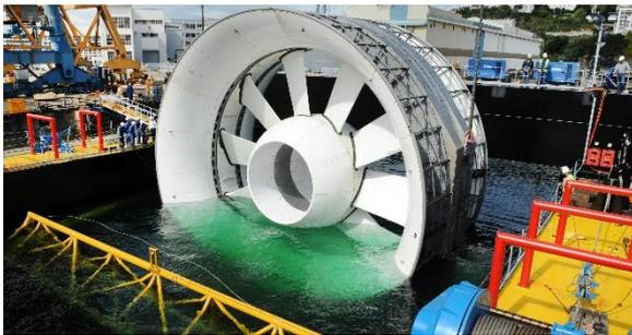
**Figure 2-1. Open Center Turbine d'OpenHydro Group Ltd avant son déploiement en Bretagne**
