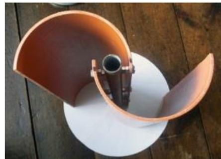
**Figure 1-3. Turbine Savonius à 2 aubes vue de dessus. Source : [Gotwind.org, 2015]**
