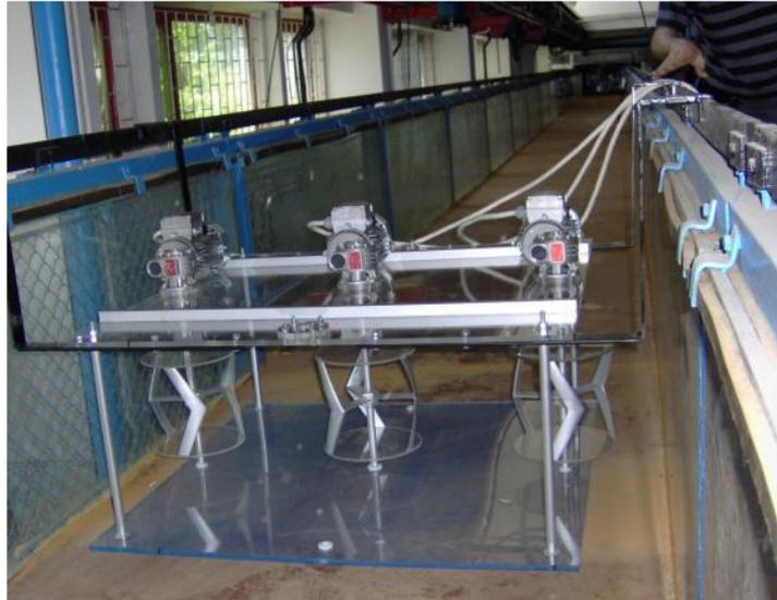
**Figure 1-35. Modèle de ferme d'hydroliennes testée à l'échelle 1:5, dans le tunnel hydrodynamique du laboratoire d'hydraulique de l'UTCB. Source : [Georgescu et al., 2010]**
