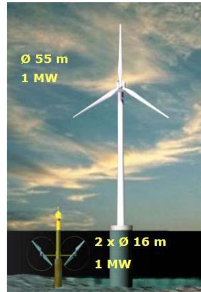
Figure 1-1. Comparaison de la taille d'une éolienne et d'une hydrolienne de même puissance
