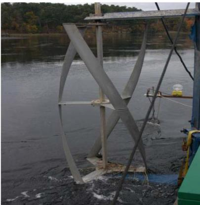
**Figure 1-10. Turbine GORLOV commercialisée par Lucid Energy Technologies**
