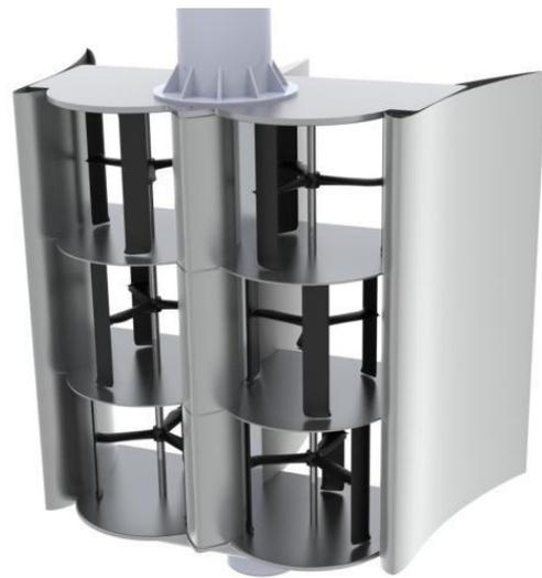
**Figure 1-42. Tour : Colonnes jumelles contrarotatives logée dans une structure de maintien avec carénage**
