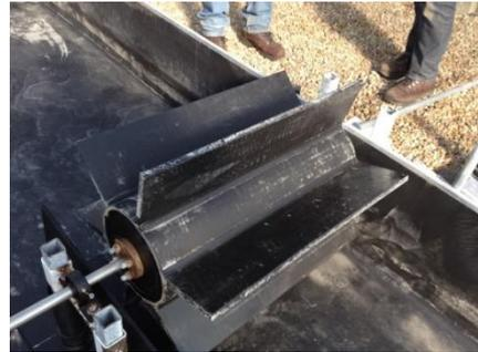
**Figure 1-2. Roue à aubes mue par les forces de traînée. Source : [AlgaConcept, 2015]**
