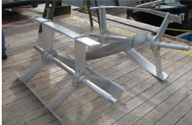
**Figure 1-11. Turbines en H et Gorlov testées par Coastal Hydropower Corporation**
