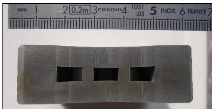
Figure 2-12 : Maquette A6_100 après découpe au fil.
