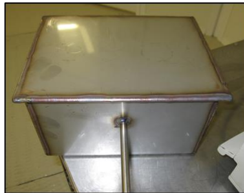
Figure 2-9 : Exemple d'un conteneur avant et après l'assemblage pour la maquette C.
