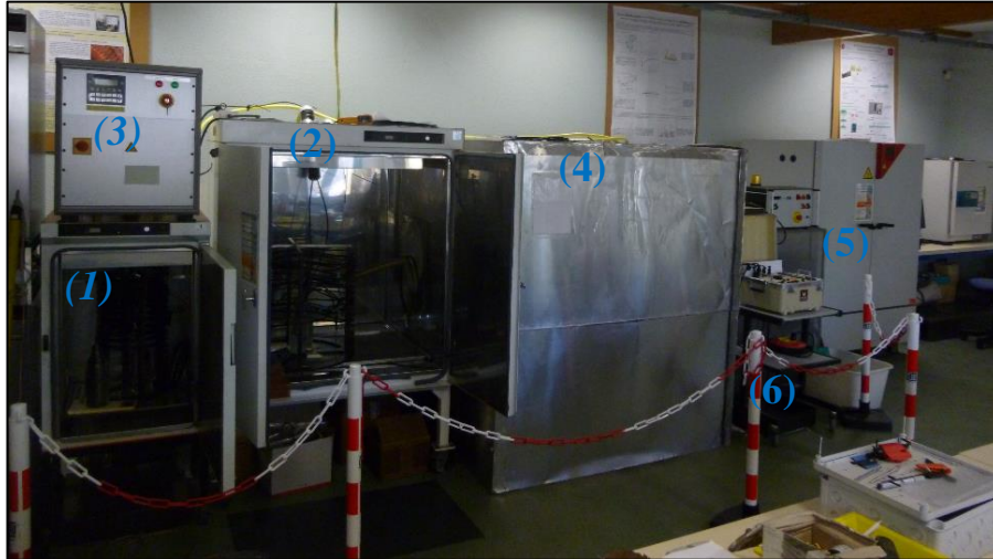
Figure 55: Installation mise en place pour le vieillissement thermoélectrique.
