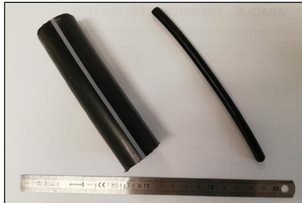
Figure 45: câble HTA réel (gauche) et mini-câble (droite).
