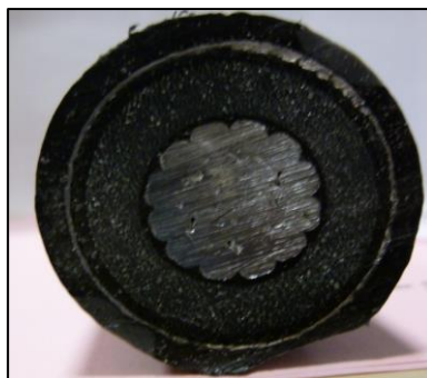
Figure 43: Câble « réel » de diamètre 4 cm, tension nominale 12/20 kV).
