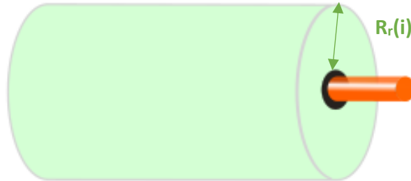
Figure 84: Définition des résistances de l'isolant à considérer
