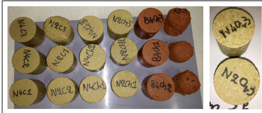
Figure IV-5 : Aspect des éprouvettes après immersion de 2 h dans l'eau
