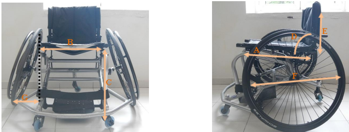
Figure 3 : Principaux réglages d'un Fauteuil Roulant Manuel de sport.
