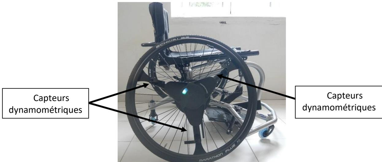
Figure 17 : La SMARTWheel®2015 Out-Front.
