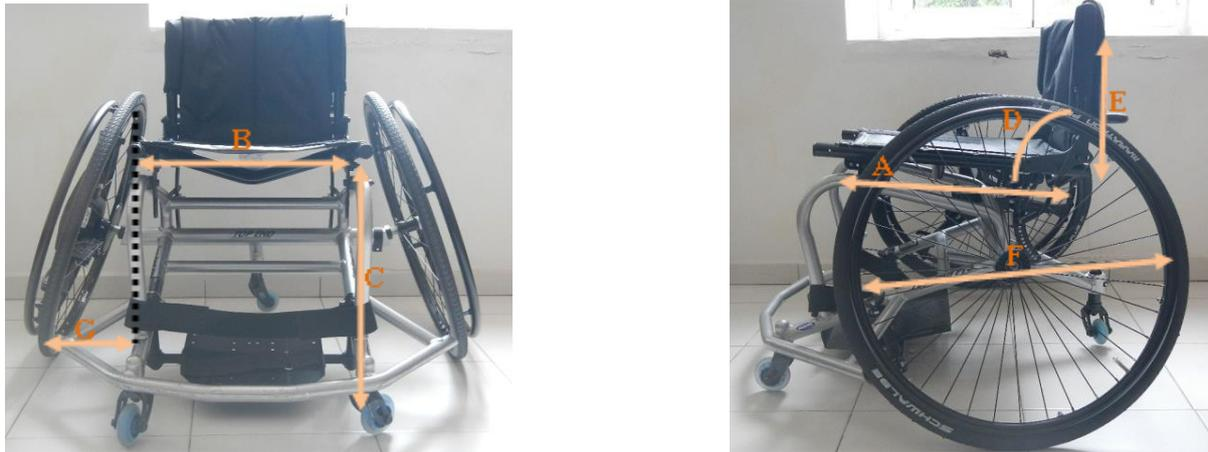
Figure 3 : Principaux réglages d'un Fauteuil Roulant Manuel de sport.
