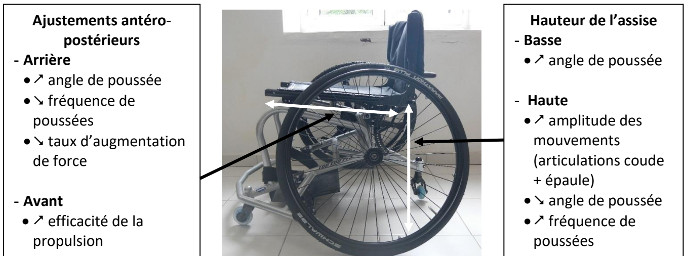
Figure 4 : Effets de deux réglages principaux d'un Fauteuil Roulant Manuel de sport.
