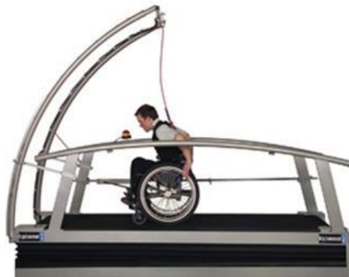
Figure 16 : Expérimentation sur tapis roulant (h/p/cosmos saturn® 300/100 r).
