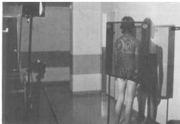
FIGURE 3.1: Principe du Moiré d'ombre ( Willner, 1979 )
