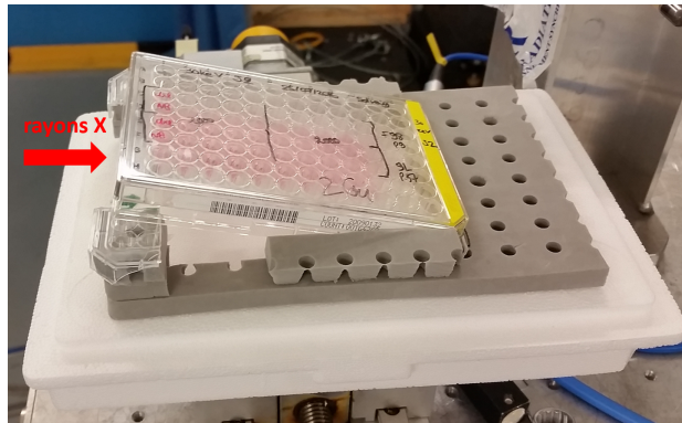
Figure 7.1 – Set-up d'irradiation des plaques 96 puits sur la ligne ID-17 (SSRT).
