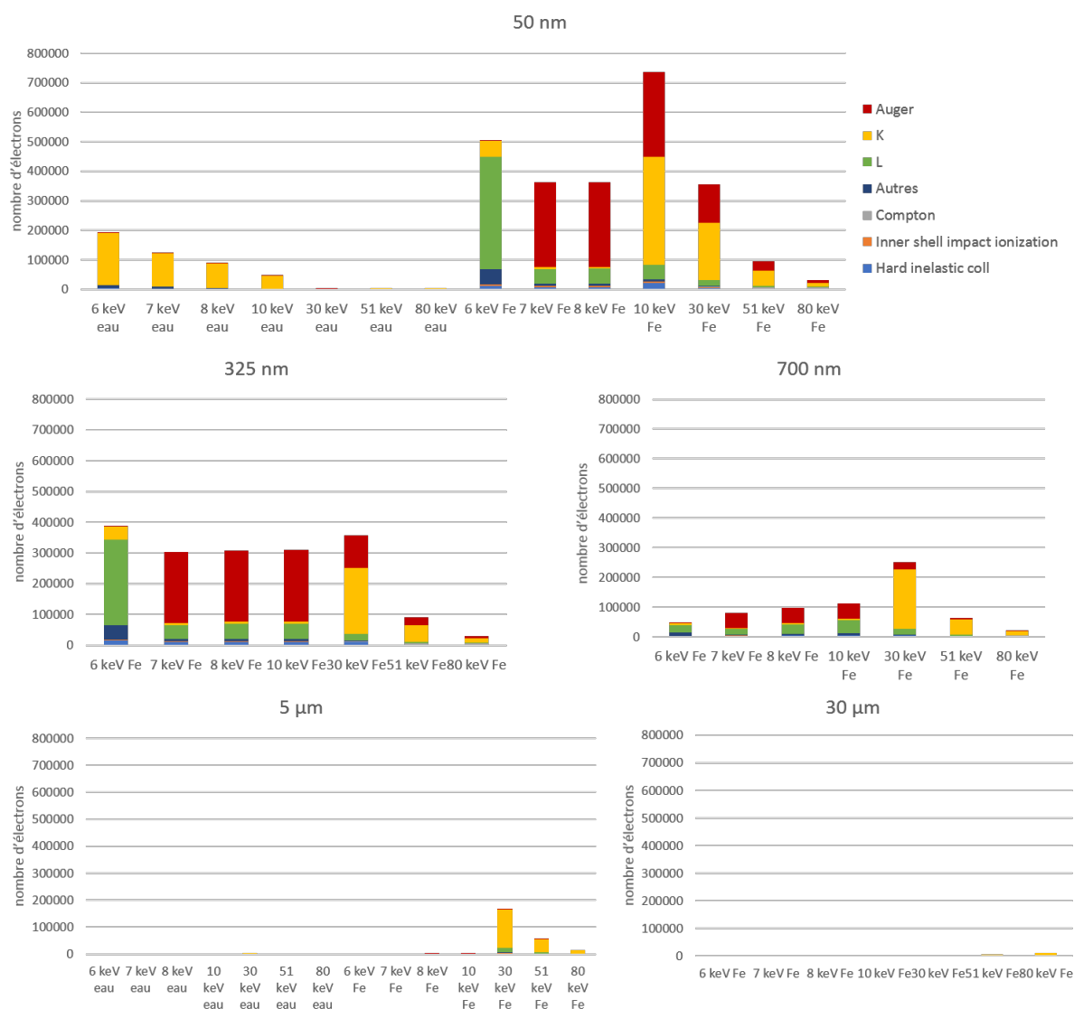
Figure 4.6 – Proportions des électrons émis sortant d'une NP d'oxyde de fer Fe_3O_4 (ou remplie d'eau) de 50 nm de diamètre, selon le processus qui les a mis en mouvement ou les interactions qu'ils ont subies (diffusion). La NP est irradiée à différentes énergies (6, 7.12, 8, 10, 30, 51 et 80 keV) et les spectres des particules secondaires sont mesurés à différentes distances radiales (50 nm, juste en surface, puis 325 nm, 700 nm, 5 μm, 30 μm). Le faisceau est ponctuel et traverse la NP en son centre.
