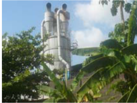
Photos 79 et 80: Cyclone d'aspiration de sciures issues de ses activités de transformations de bois
