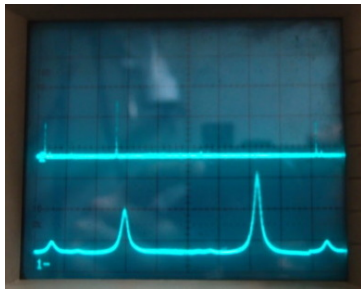
FIGURE 2.30 – Injection simultanée des deux cavités par la source fine lors d'un balayage en fréquence. En bas, transmission de la cavité basse finesse et en haut celle des modes de la cavité haute finesse.
