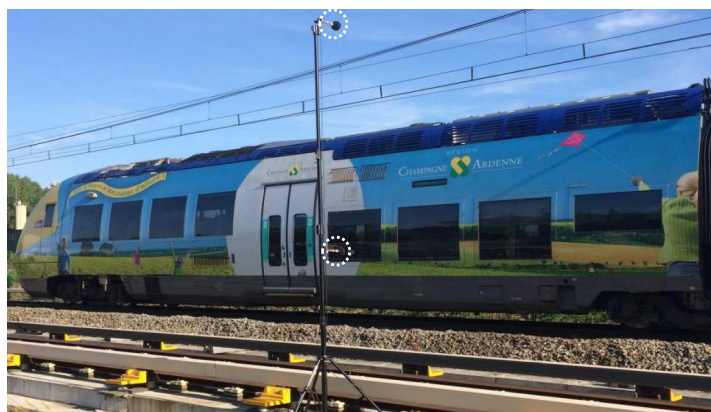
FIGURE 4.1: Mesure acoustique à 7.5 m au passage du train : les deux microphones sont placés à 1.2 m et 3.5 m au-dessus du rail.
