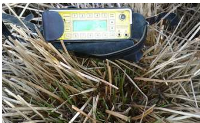
Photo 20 : Le récepteur sans son antenne permet de retrouver (en général) l'émetteur qui est tombé, en parcourant lentement le sol. © F. Darinot.
