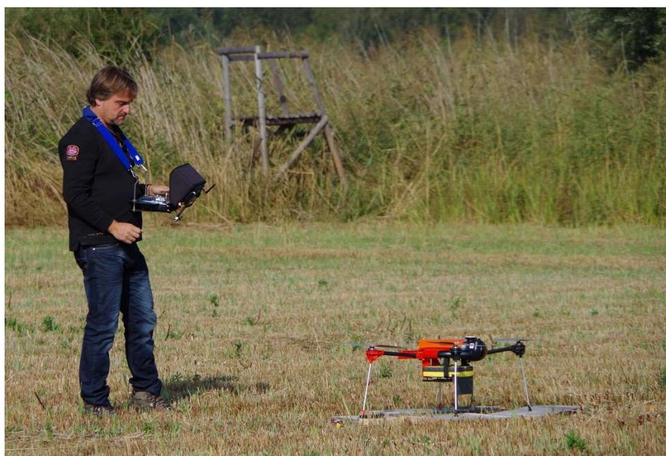
**Photo 24 : Récepteur RECCO R9 fixé sous le drone, en position horizontale © Y. Rozier.**
