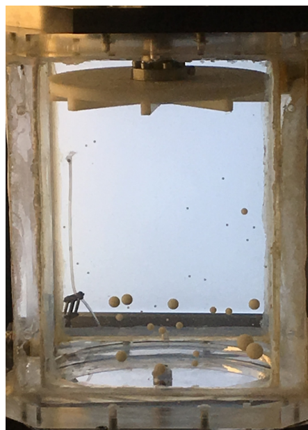
FIGURE 19 – Image de particules de polyamide en suspension dans un écoulement de von Kármán vertical à un disque
