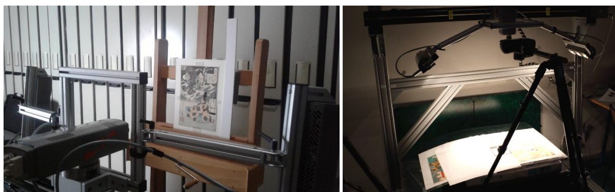
Figure II.5. Caméras hyperspectrales : à gauche, caméra HSI VNIR montée sur rail © A. Mounier ; à droite, caméra HSI VNIR IQ sur trépied © C. Biron
