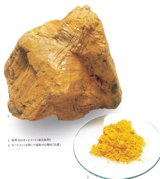
Figure A. 41. Orpiment naturel et poudre d'orpiment (d'après Furihata et al. , 2016, p.142)
