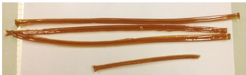
Figure I.17. Colle de peau ( nikawa ) de vache sous forme de bâton (environ 30 cm de long)
