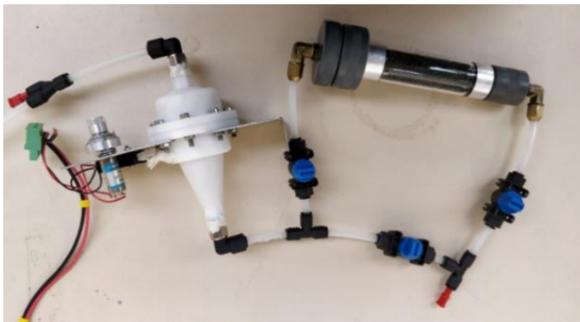
Figure 5.29 : Photographie de la turbine conçue par Patrick Magnier et David Attié et de la capsule permettant de filtrer l'oxygène et l'humidité.
